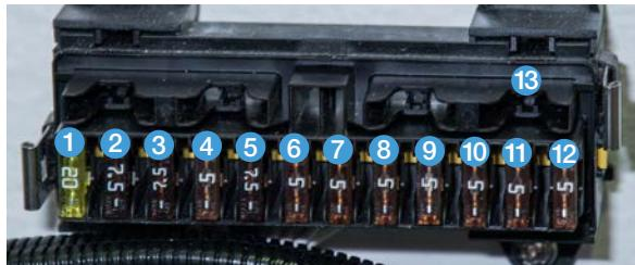
**ATTENZIONE. Rischio di esplosione.** Utilizzare solo fusibili conformi a SAE J1171 (protezione anti-innesco). I fusibili/interruttori con protezione da sovraccorrente sono da 30 A e si trovano accanto al sezionatore batteria.
